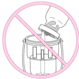
注意 支持筒を正立にして薬剤瓶を接続すると、薬剤が注入針の針穴を通じこぼれることができます。また、薬剤瓶のゴム栓周辺部又は斜めに刺すとゴム栓が薬剤瓶内に脱落したり、注入針が変形・折損したりすることがあるのでご注意下さい。
