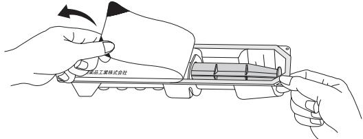
②バレル部分を持って取り出して下さい。プランジャーを持って取り出すとガスケットとプランジャーに緩み・ガタつき・外れが生じたり又は薬液が漏出するおそれがあります。
